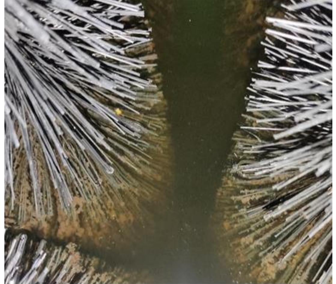
Bürsten im Sedimentationsbecken nach 48h mit (links) und ohne (rechts) Maden-Zufütterung
